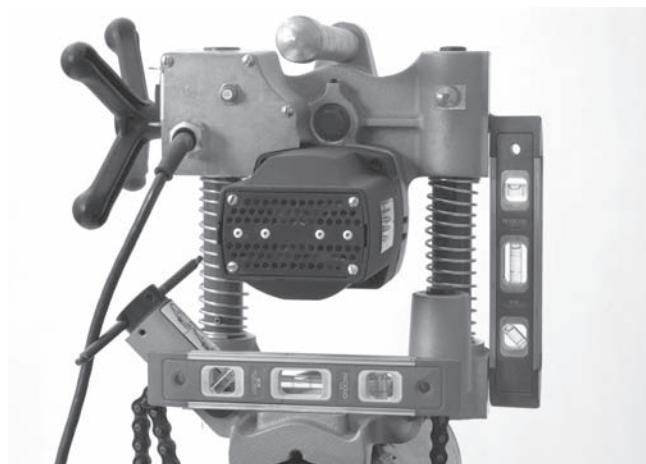
Slika 10 – Izravnavanje modela HC-300
