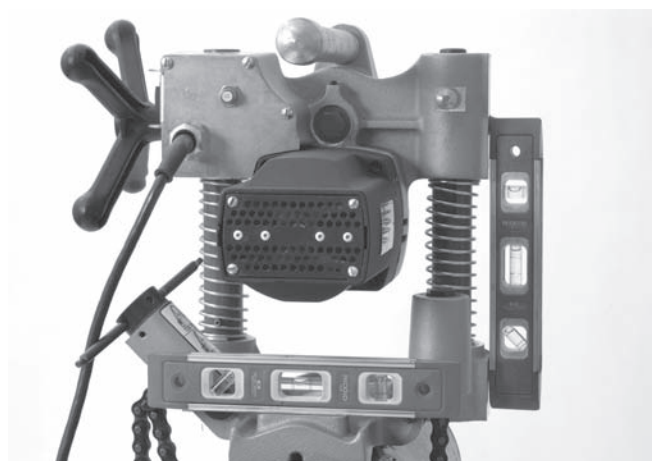
Figura 10 – Nivelamento da HC-300
