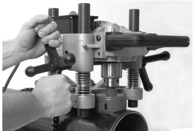
Figura 11 – Perforadora en funcionamiento
