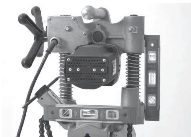
10. ábra – A HC-300 kiszintezése
