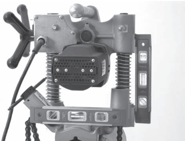
Figuur 10 – Waterpas zetten van de HC-300
