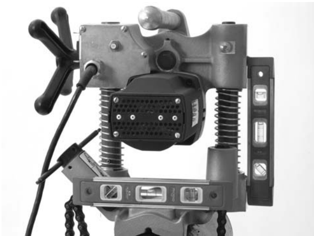
Figura 10 – Nivelación de la HC-300
