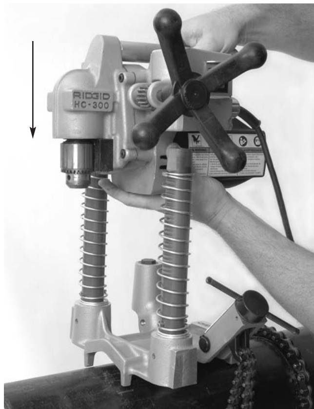
Figure 9 – Montage du moteur de la HC-300 sur son embase
