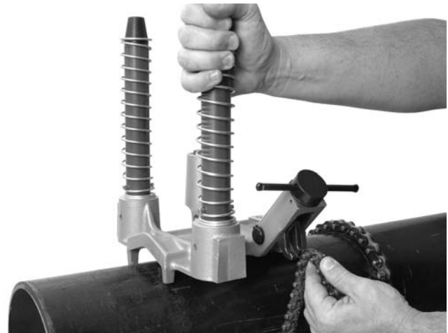
Figure 8 – Accrochage de la chaîne
