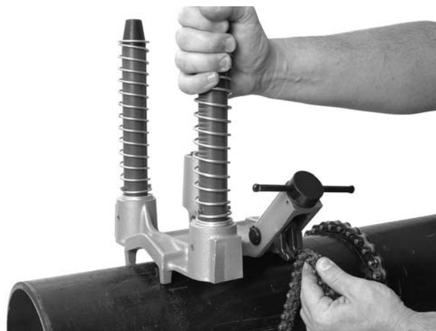
Figura 8 – Enganche de la cadena de la HC-300
