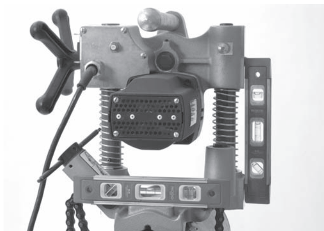
Obrázek 10 – Vyrovnání modelu HC-300
